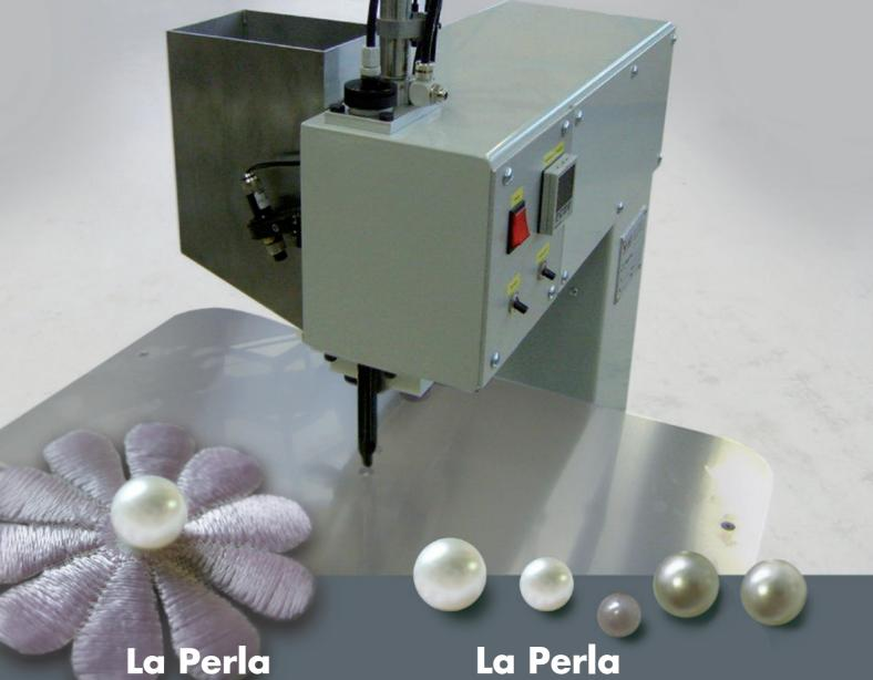
Manuelle Maschine für direkte Bestückung auf Textil
